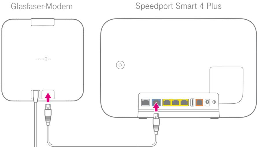
Schließen Sie ein beliebiges Netzwerk-Kabel an die Link-Buchse des Glasfaser-Modems und die blaue Link/LAN1-Buchse Ihres Speedport an.
