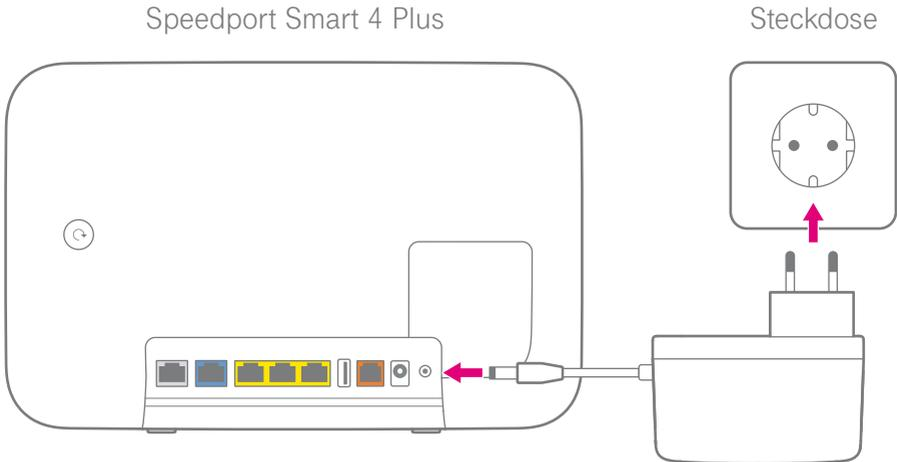
Schließen Sie das mitgelieferte Netzteil an Ihren Speedport und an eine Steckdose an. Die automatische Einrichtung Ihres Speedport beginnt und kann bis zu 15 Minuten dauern.
