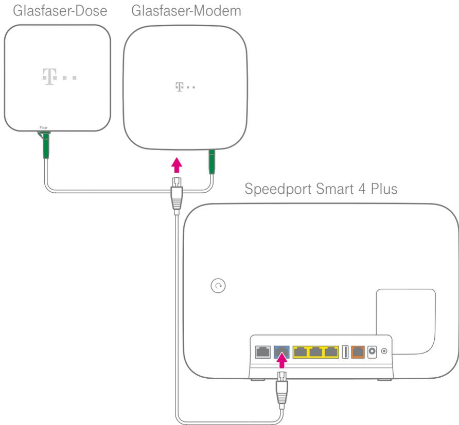
Schließen Sie ein beliebiges Netzwerk-Kabel an die Link-Buchse des Glasfaser-Modems und die blaue Link/LAN1-Buchse Ihres Speedport an.
