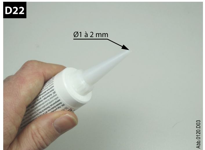
Die Kartuschenspitze anbringen und am Ende abschneiden - Klebstoffaustrittsöffnung von \varnothing 1 bis 2 mm.
